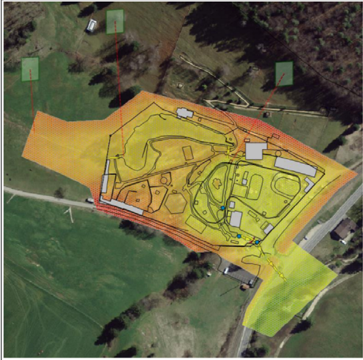
Figure 14 : Topographie et objets hydrauliques (tuyaux et grilles en jaune)
